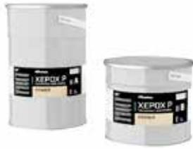
Zweikomponenten-Epoxydkleber mit sehr geringer Viskosität und hoher Fließkraft für Verstärkungen mit Bändern/Gewebe aus Kohlenstoff oder Glas. Auch für den Schutz von sandgestrahlten Blechen SA2,5/SA3 (ISO 8501) und für die Herstellung von FRP-Einsätzen (Fiber Reinforced Polymers) geeignet. Anwendbar mit Rolle, Spray und Pinsel. Kann 36 Monate in der ungeöffneten Originalverpackung bei Temperaturen zwischen +5°C und +30°C gelagert werden.
